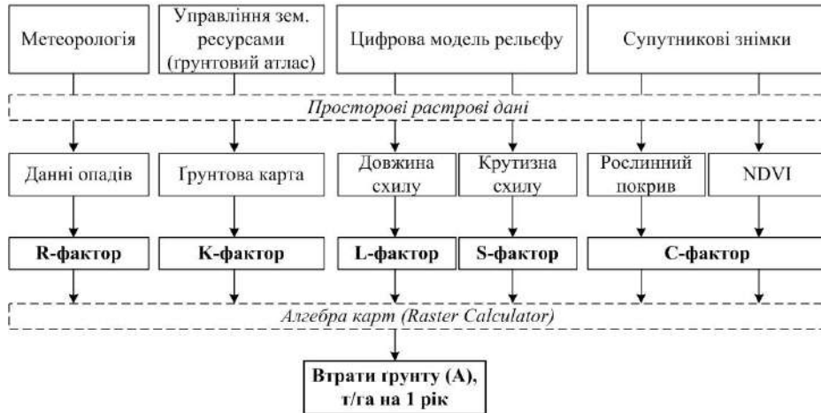
Рис. 4. Блок-схема алгоритму використання моделі RUSLE
