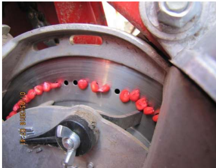
Рис. 2 – Незаповненість насінням кукурудзи висівачного диску
