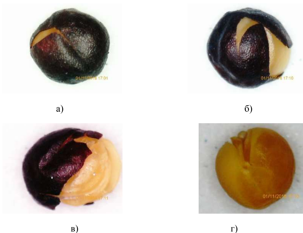
Рис. 3 – Світлини травмованих насінин озимого ріпаку з мікропошкодженнями (а) та макропошкодженнями (б, в, г)
