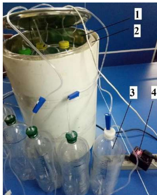
1 – реактор, 2 – нагрівальний пристрій, 3 – газгольдер, 4 – терморегулятор МТР-2
