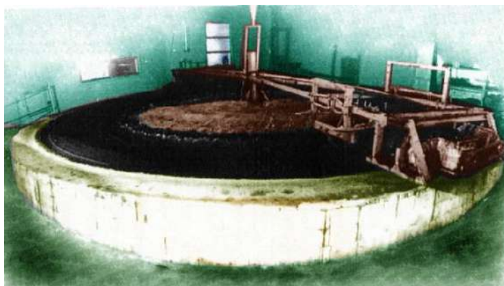
Рис. 2 – Загальний вигляд установки для випробування дисків сошників на знос
