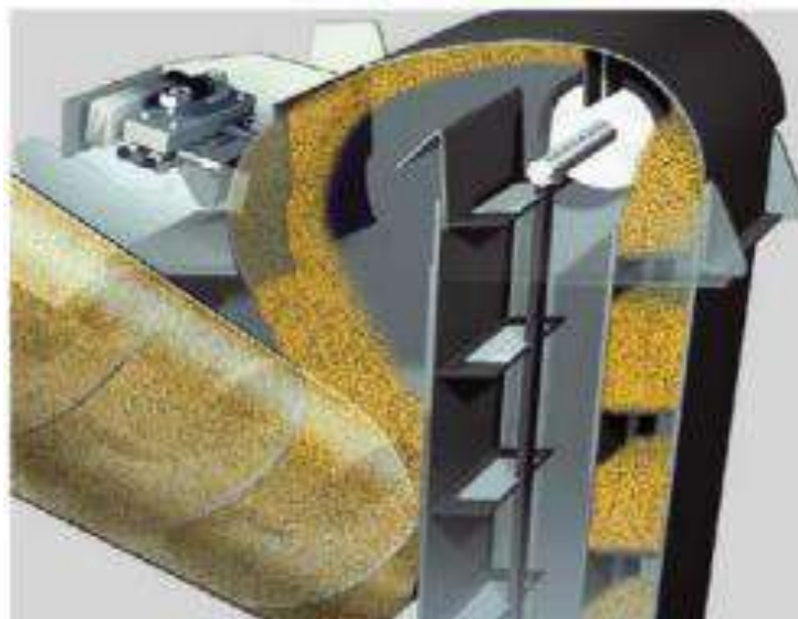
Рис. 2 - Датчик потоку для визначення потоку зерна [0]
