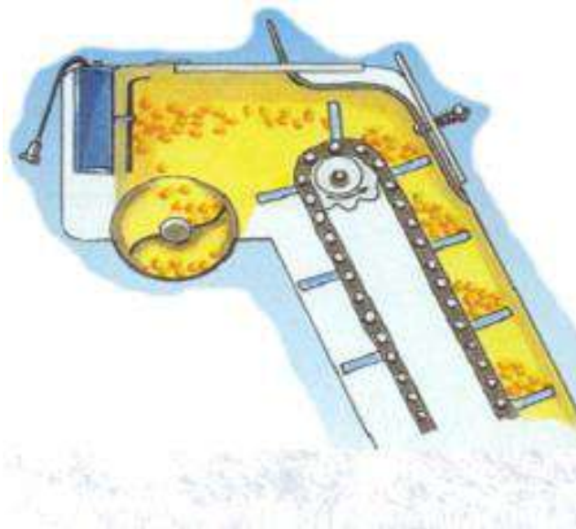
Рис 4 - Схема розташування сенсора сили удару в елеваторі комбайна [0]
