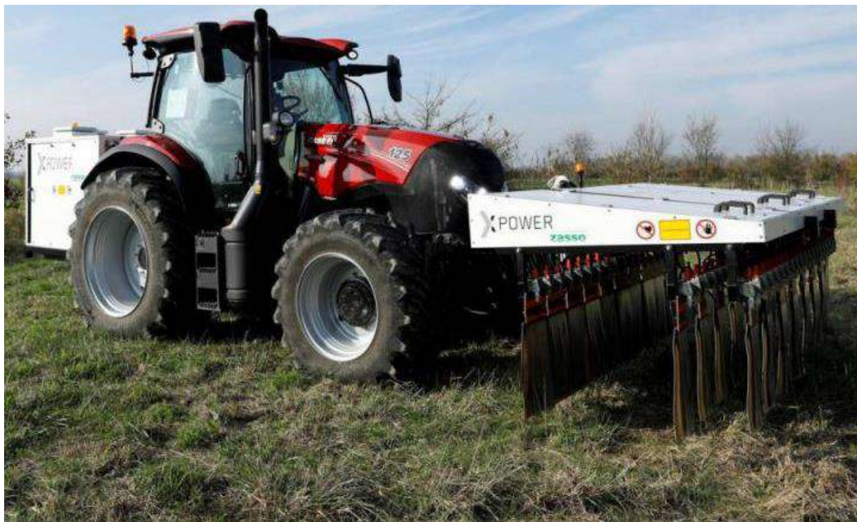
Рис. 3 - Система боротьби з бур'янами Xpower
