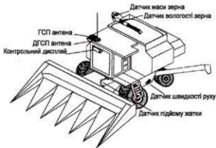
Рис. 1 - Комплект обладнання для картографування врожайності [0]
