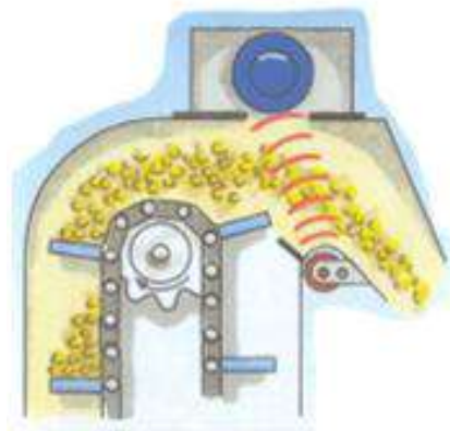
Рис. 7 - Радіометрична система визначення врожайності зерна [0]
