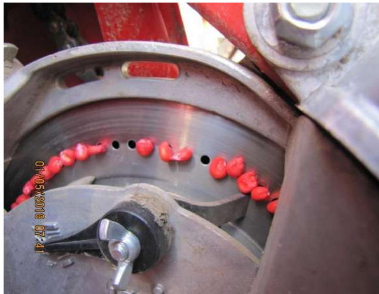
Рис. 2 – Незаповненість насінням кукурудзи висіваючого диску
