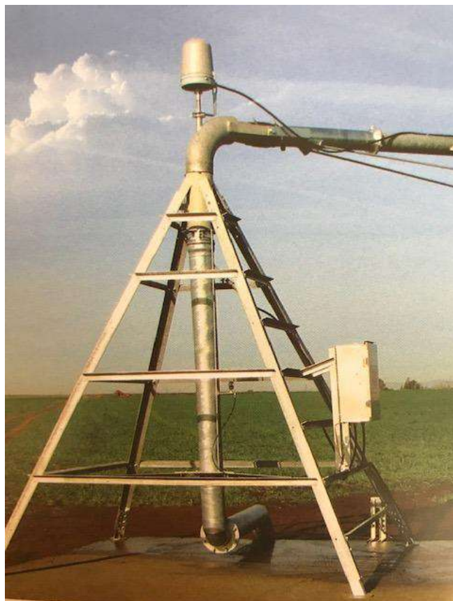
Рис. 1 – Центральная опора дождевальной машины Western серии CP600
