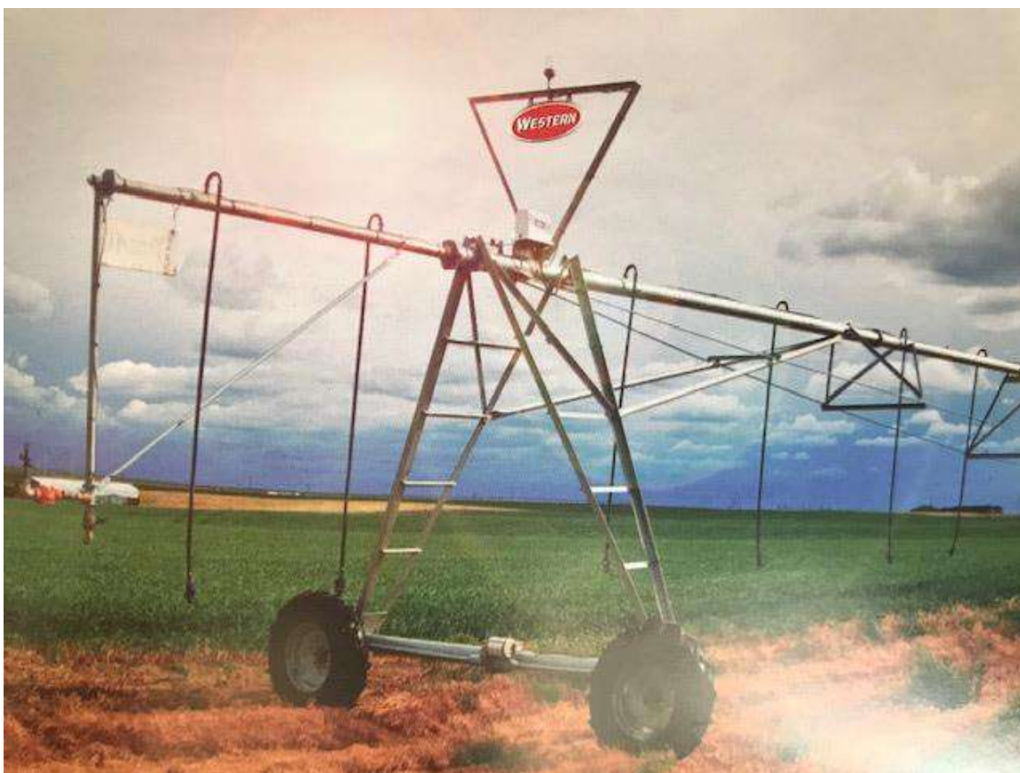
Рис. 2 – Консоли дождевальной машины Western серии CP600
