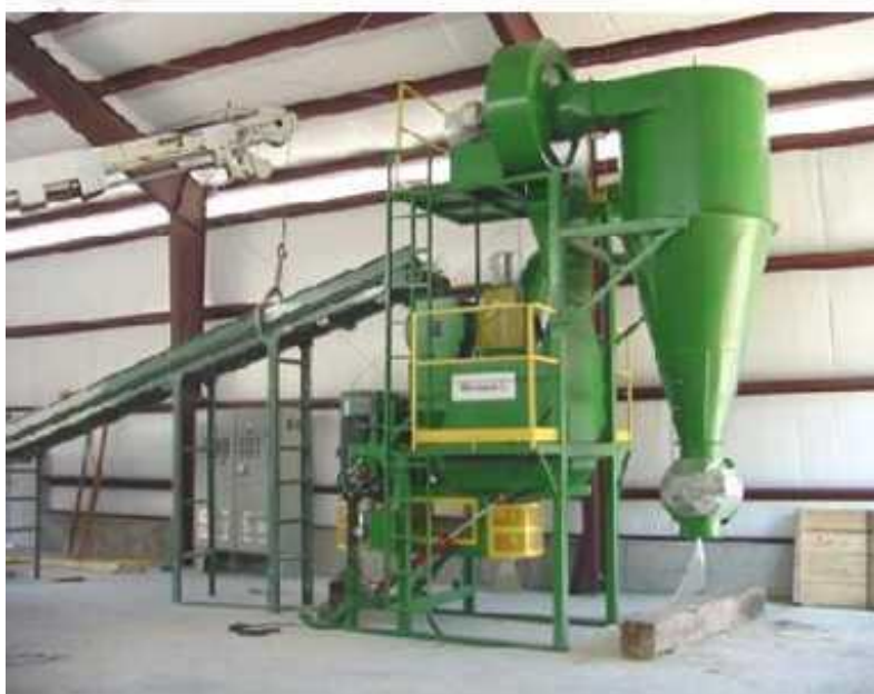
Рис. 1. Сушка курячого посліду в системі BPS
