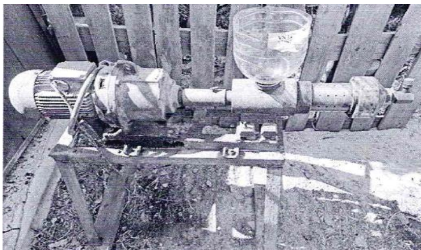
Рисунок 1 - Загальний вигляд шнекового пристрою для виготовлення біопаливних пелет на основі мулових осадів стічних вод
