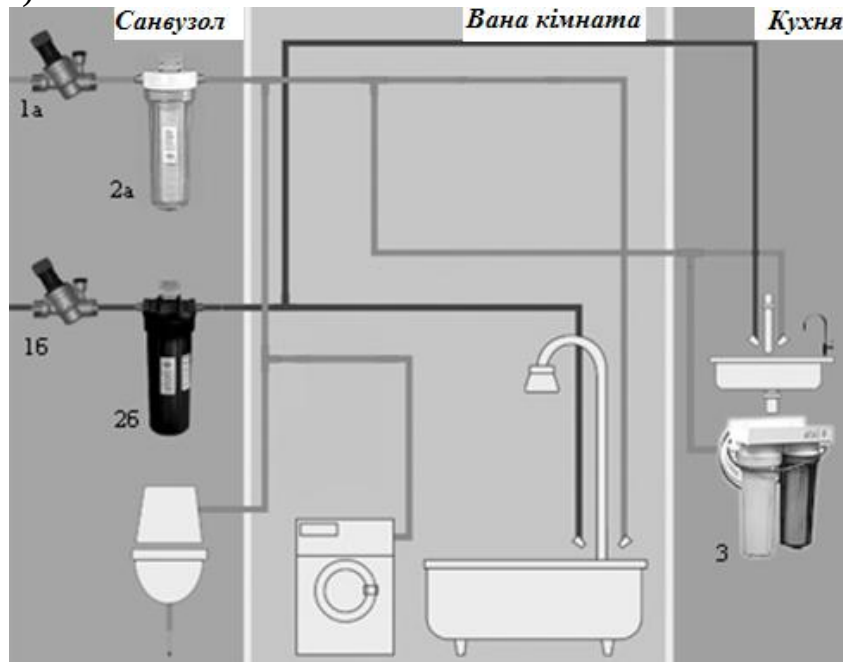
Рис. 1. Схема очищення води в квартирі (економічний варіант):
