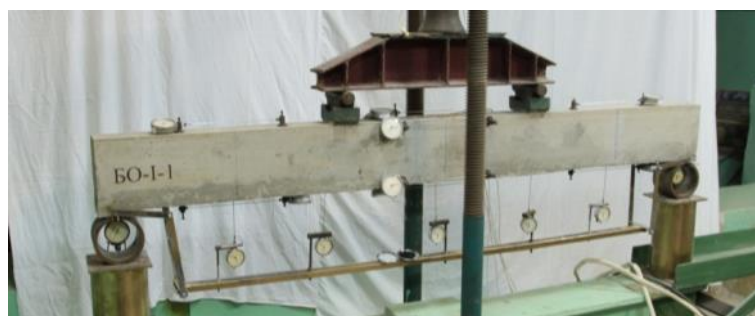
Рис. 1 - Фото випробування підсиленої балки серії БО-I-I
