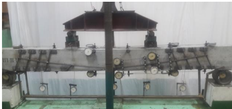
Рис. 2 - Фото випробування підсиленої балки серії БПП-III-I
