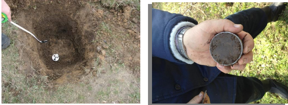
Рисунок 1 - Послідовність відбору з шурфів проб ґрунту дамб каналів на щільність.
