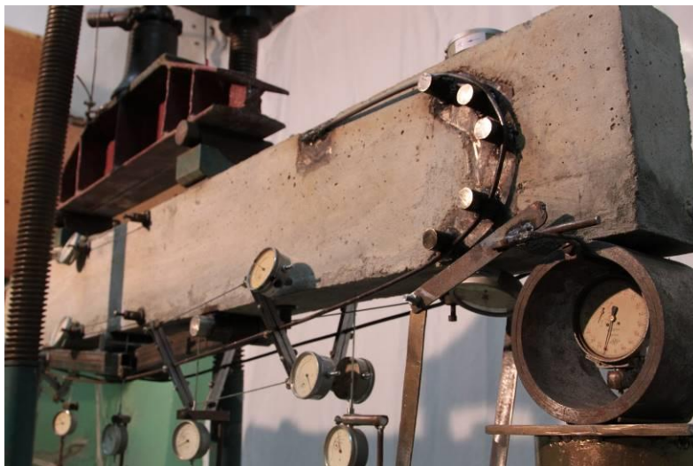
Рисунок 2 - Загальний вигляд підсиленої серії балок під час випробування.
