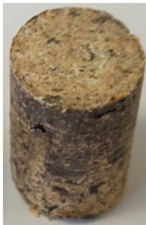
Рисунок 2 – Вигляд зразка гранули, виготовленого з суміші мулових осадів 30% і тирси 70% (діаметр 16 мм, довжина 20 мм), при тиску 130,5 МПа
