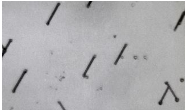
Рис.2. Поверхня кремнієвої епітаксильної структури з виявленими окислювальними дефектами упакування після термічного окислення. Збільшення 507 x
