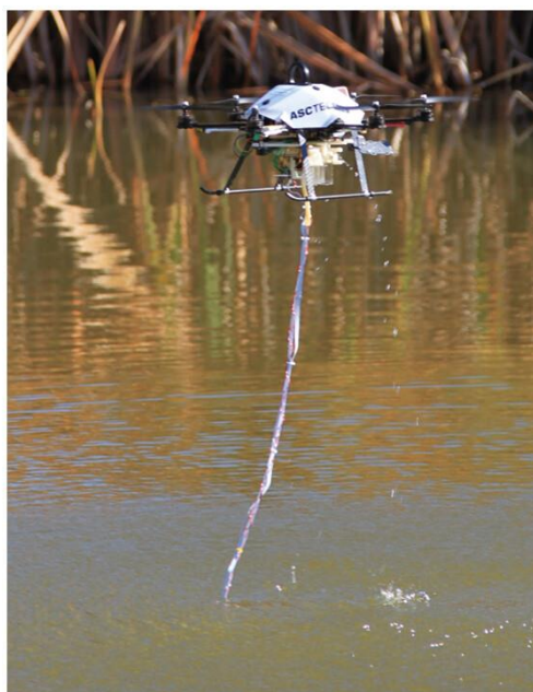
Рис. 1. Спосіб відбору проб води для визначення її якості за допомогою дрона (джерело: [4])
